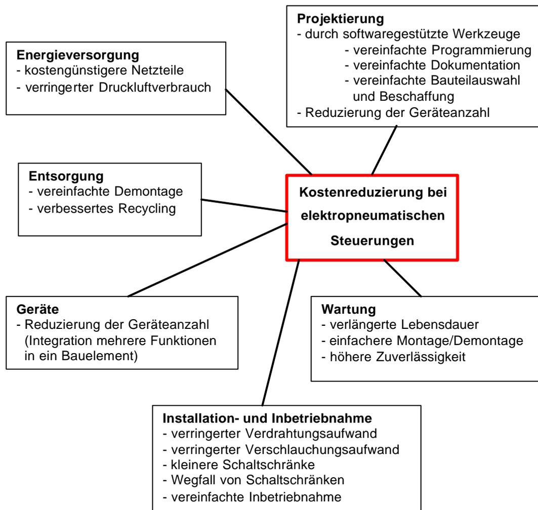
Abb.3.13: Kostenreduzierung bei elektropneumatischen Steuerungen
