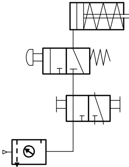
Bei Betätigung des Tasters am oberen 3/2 Wegeventil strömt die Luft in den Kolbenraum des Zylinders. Der sich aufbauende Druck bewegt den Kolben gegen die Kraft der Kolbenrückstellfeder nach vorn. Bei Freigabe des Drucktasters setzt die Ventiltfeder das 3/2 Wegeventil wieder in die Ausgangsstellung, die Kolbenstange fährt ein.
