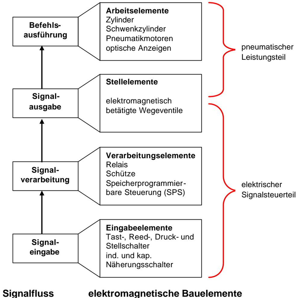
Abb. 3.7: Signalfluss und Bauelemente einer elektropneumatischen Steuerung
